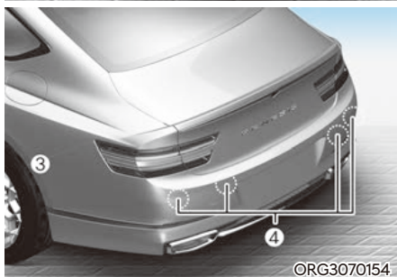
[1]: 전방 초음파센서, [2]: 전측방 초음파센서, [3]: 후측방 초음파센서, [4]: 후방 초음파센서
